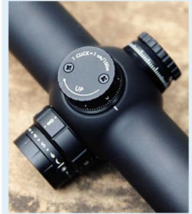
Let op dat die stelknop van die teleskoop kloksgewys gedraai moet word om die geweer hoër te laat skiet. Dis andersom met die meeste fabrikate.
