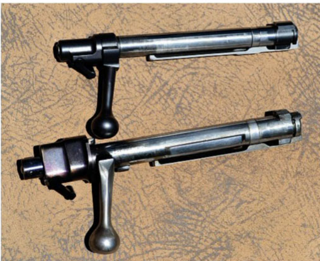
Let op hoe klein (amper fingerig) die Kimber se slot is (bo) in vergelyking met dié van 'n M98-Mauser. Die Kimber-slot het egter genoeg staal in die regte plekke om te verseker dat dit sterk genoeg is.
